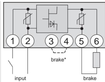
Fig.: Phase rectifier
