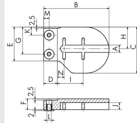
Fig.: Left bracket (B) PE
