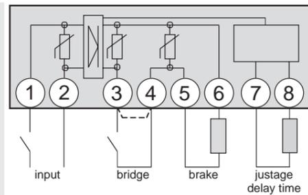
Fig.: Fast-acting rectifier
