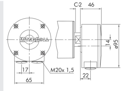
Fig.: Terminal box, aluminum
