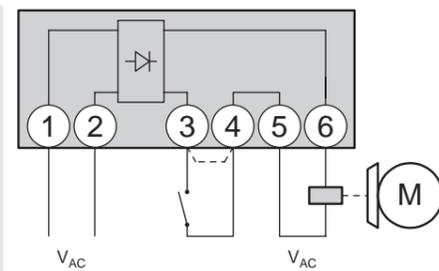
Fig.: Multiswitch rectifier
