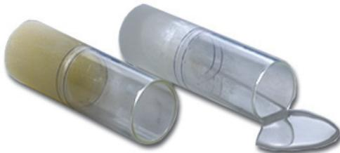
Abb.: Viskosität von paraffinischen (links) und naphthenischen (rechts) Isolierölen bei niedrigen Temperaturen.
