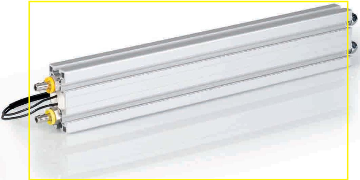
Bei Widerständen mit Wasserkühlung entsteht am Einsatzort nicht die sonst übliche Wärmeentwicklung. Bei Bremsvorgängen wird die elektrische Antriebsenergie in Wärmeenergie umgewandelt. Diese Wärmeenergie wird vom Kühlwasser aufgenommen und kann so wieder nutzbar gemacht werden. Während bei kleineren Leistungen das Kühlmittel Wasser direkt durch das Widerstandsprofil geleitet wird, kommen bei Leistungen  $> 50 \text{ kW}$  auch Wärmetauscher zum Einsatz.
